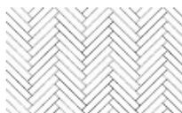
Einstabdielen Élégance by adler 2-schichtiger Massivholzaufbau mit querverleimter Trägerschicht, formstabil durch überwiegend stehende Jahresringe, Nut und Feder, aus Fichte/Tanne massiv – für Fischgrat- oder Würfelverlegung (linke und rechte Stäbe)
